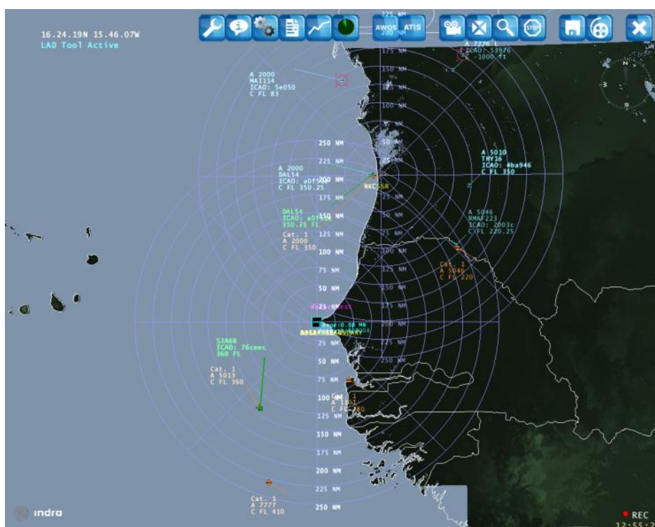
Vue du VR3000 intégrant les données radars (Dakar et Nouakchott) et ADS-B
